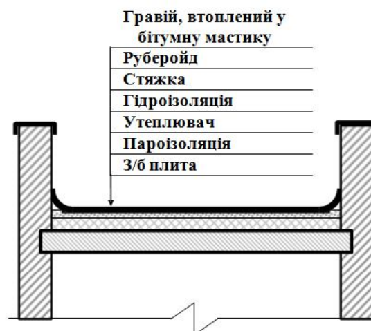
Рисунок 2.3 – Схема суміщеного дахів, що не вентиліюються
