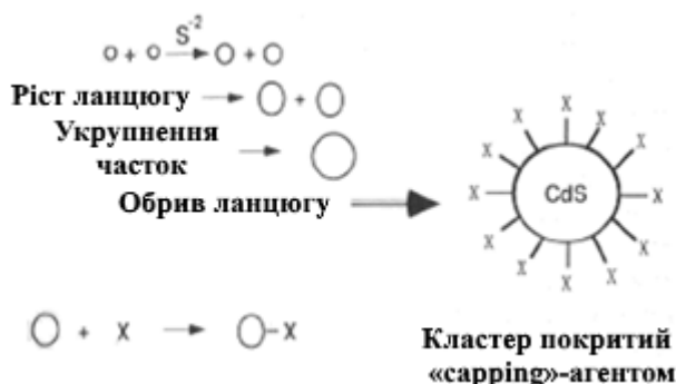
Рисунок 1 – Схема синтезу кластерів CdS, вкритих тіофенолатом (X – тіофенолатний іон)
