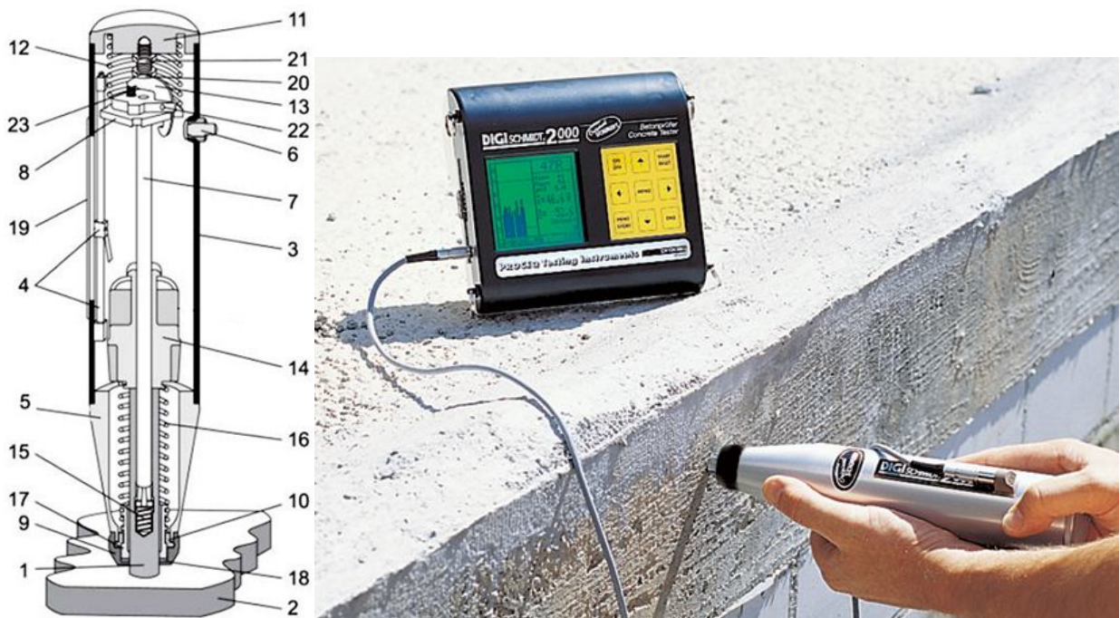
Рисунок 2.2 – Молоток Шмідта: а – схематична будова; б – приклад використання;
