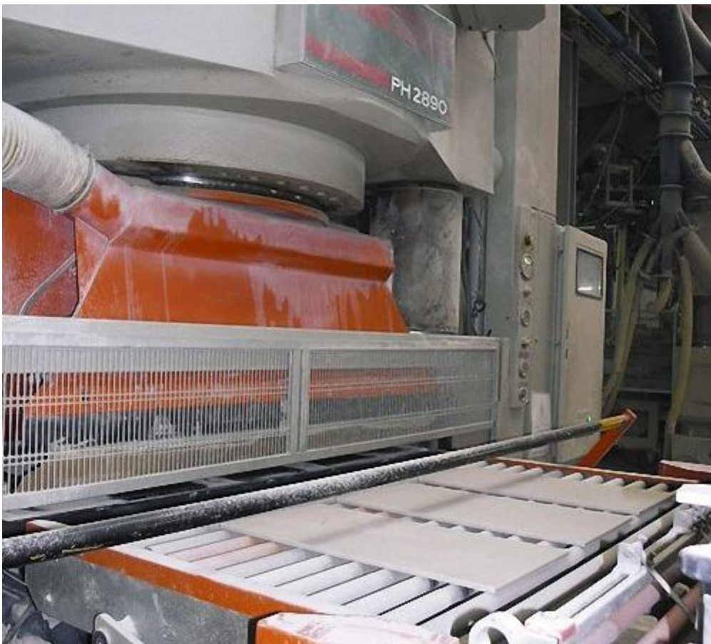
Рисунок 6.4 – Формування плитки з керамічних порошків
