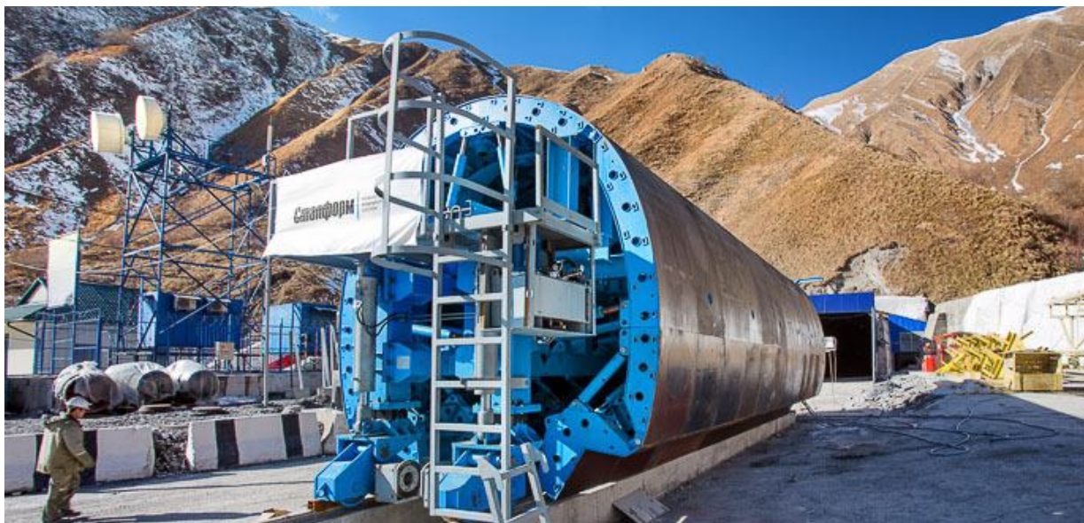
Рисунок 1.15 – Котюча опалубка для бетонування лінійно протяжних споруд
