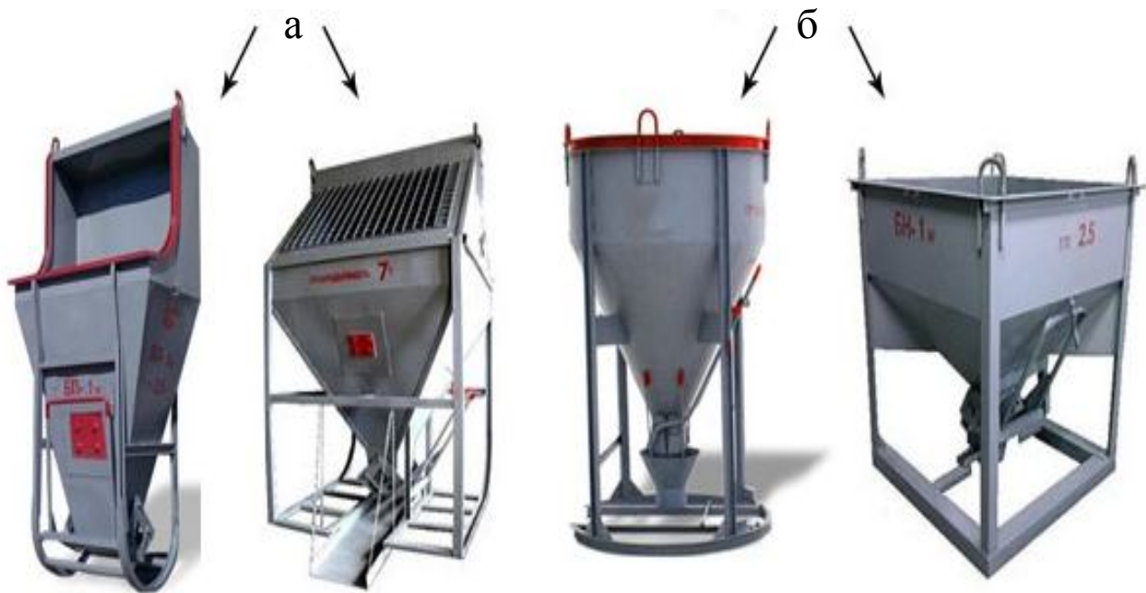
Рисунок 4.4 – Бадді для кранового подавання бетонної суміші: а – поворотна; б – неповоротна
