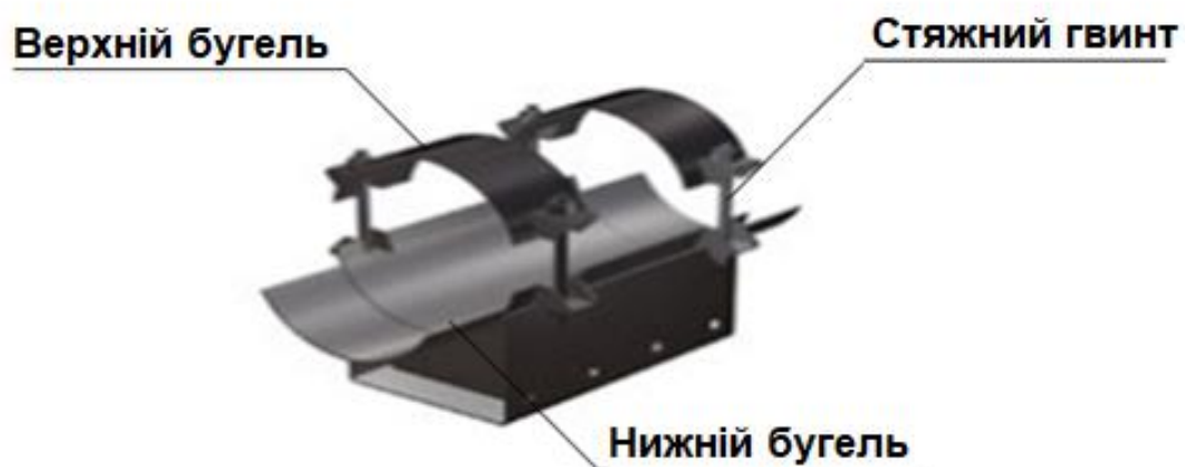
Рисунок 7.33 – Нерухома бугельна опора
