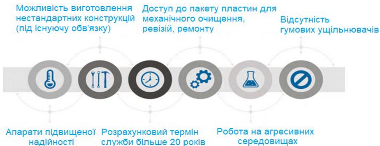
Рисунок 9.5 – Унікальні особливості зварних пластинчастих теплообмінників з розбірним корпусом
