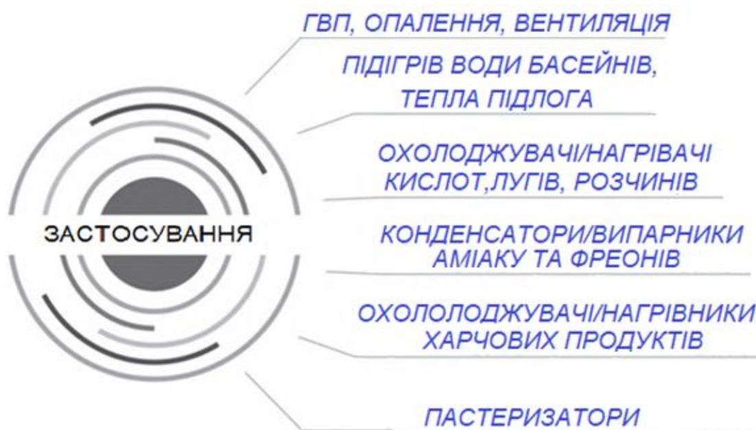
Рисунок 9.6 – Сфера застосування пластинчастих теплообмінників
