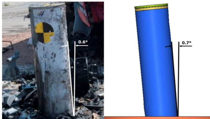
Рис.1.19. Порівняння кутової деформації стовпчика між фізичним випробуванням та скінченно-елементним моделюванням [40].
