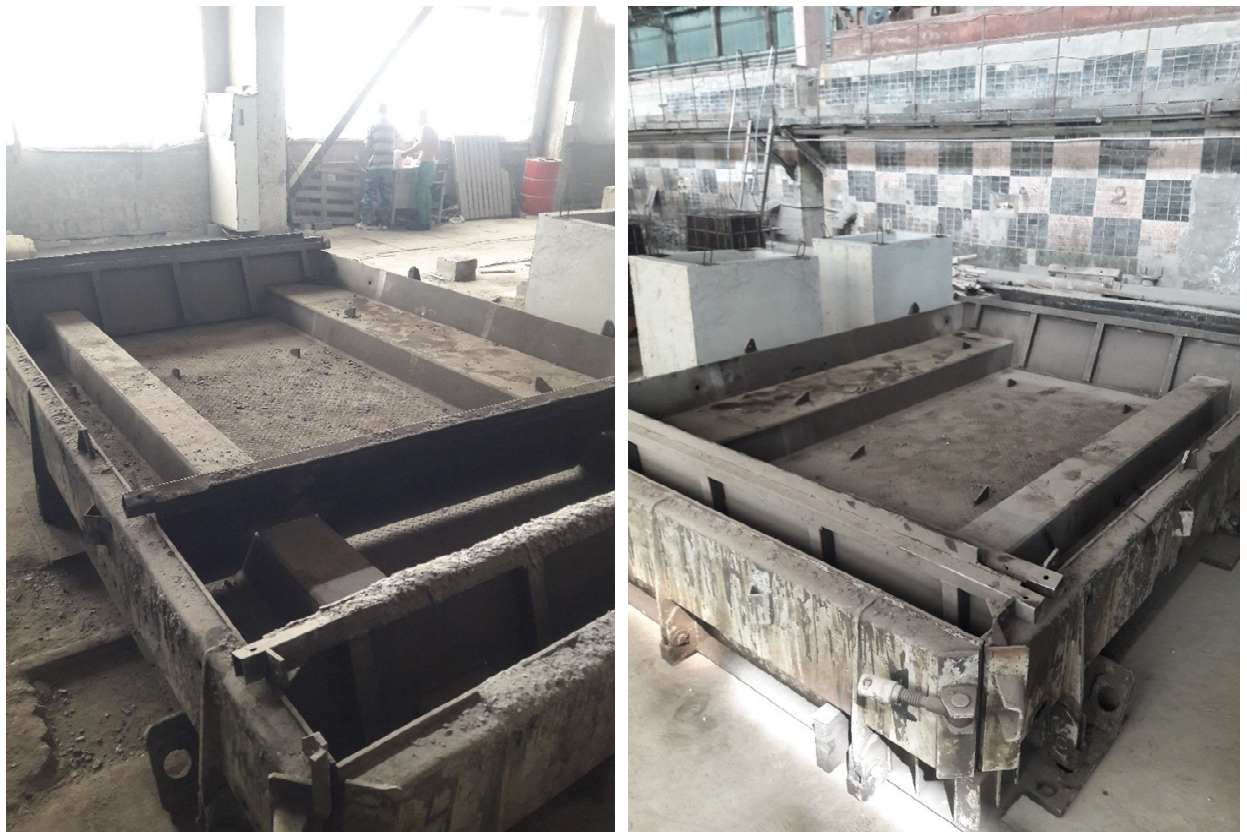
Рисунок 4.14 – Сталева опалубка пішохідної плити
