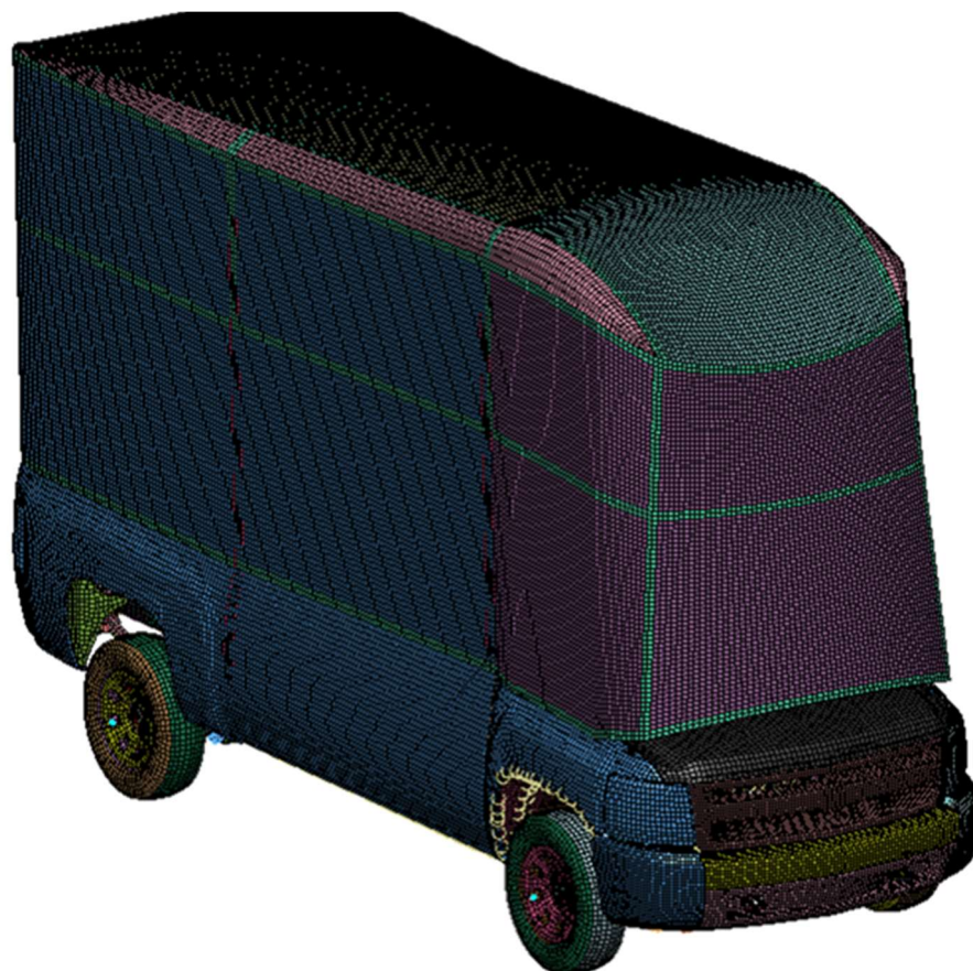
Рис. 3.21. Кінцево-елементна модель автомобіля Large ADS “Т-Pod”.
