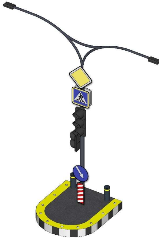
Рис. 2.12 – Приклад розміщення світлофорної стійки та болардів на рефюджі.
