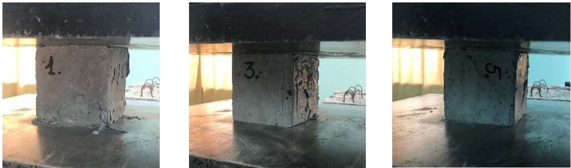
Рисунок 4.3 – Стандартні випробування по визначенню кубикової міцності бетону на стиск в пресі ПСУ-250
