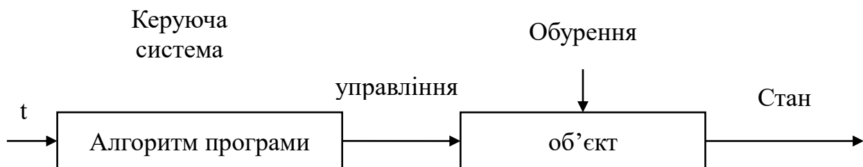
Рисунок 5.6 – Принцип розімкнутого управління
