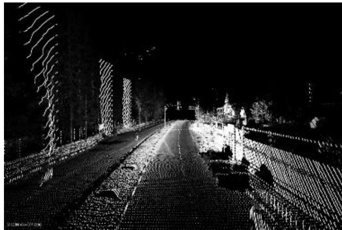
Рисунок 8.2 – Результати сканування у вигляді хмари точок
