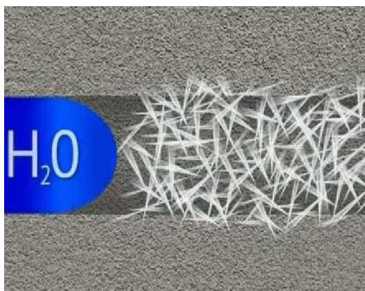
Рисунок 15.5 – Принцип дії проникної гідроізоляції
