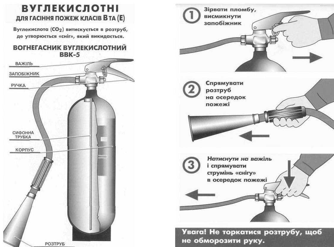
Рисунок 16.6 – Будова і порядок приведення в дію ВВК-5
