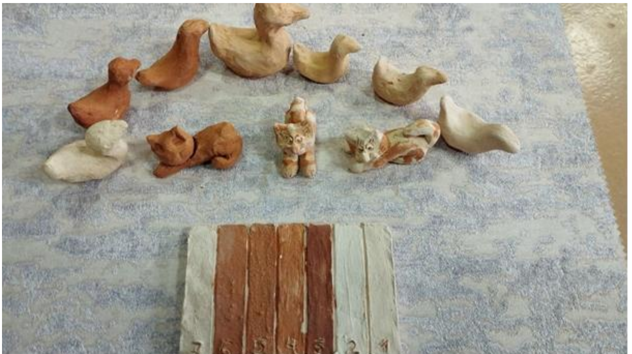
Рис. 6. Визначення фізичних властивостей відібраних проб з Валківського кар'єру у випаленому стані (фото автора від 19.11.2023)
