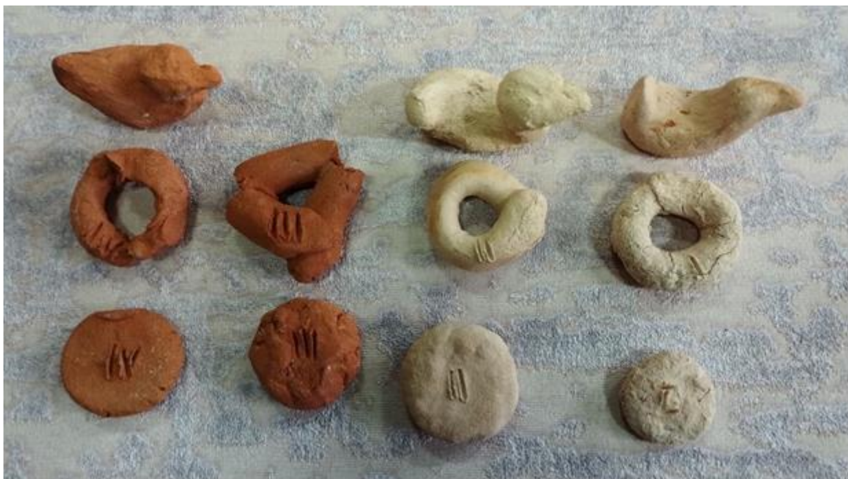
Рис. 4. Визначення фізичних властивостей відібраних проб з Валківського кар'єру у підсушеному стані (фото автора від 19.11.2023)
