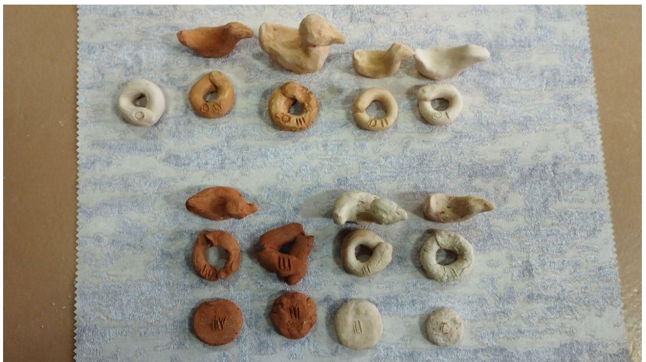
Рис. 7. Фізичні властивості сумішей відібраних проб з контрольною пробою (Слов'янська керамічна маса МКФ – 2, додаток Б) (фото автора від 19.11.2023)
