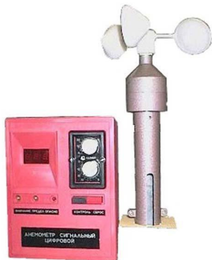
Рис. 1.2. Чашкові анемометри : а) (М 95ЦМ) [21], б) (АРЕ-М) [20]
