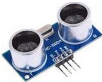
Рис. 2.2. Ультразвуковий датчик відстані HC–SR04 [16]
