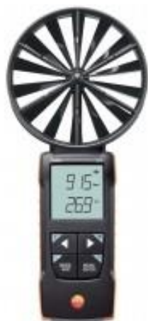
Рис. 1.4. Крильчасті анемометри: а) (Testo 416) [8], б) (АПР2) [6]
