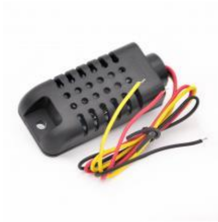
Рис. 2.3. Датчик вологості та температури DHT21 [15]
