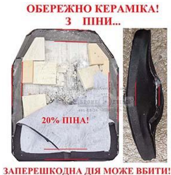
Рис. 1.1. Результат влучання у неякісну керамічну бронепластину [7]
