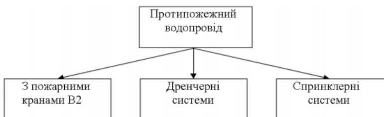
Рисунок 4.10 – Класифікація протипожежного водопроводу
