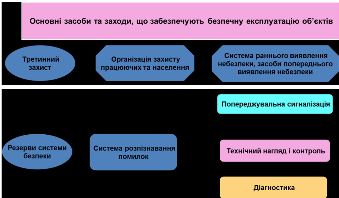
Рисунок 2.6 – Треступінчаста схема забезпечення безпечного стану об'єктів: (третинний захист)
