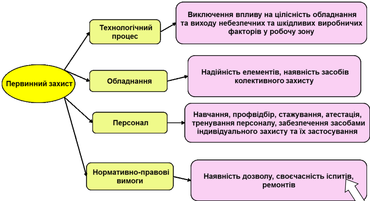
Рисунок 2.4 – Триступінчаста схема забезпечення безпечного стану об'єктів: (первинний захист)
