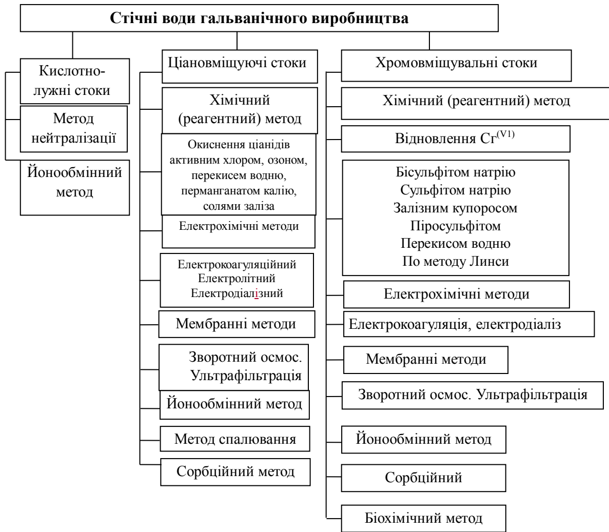
Рисунок 8.1 – Методи очищення стічних вод гальванічних виробництв
