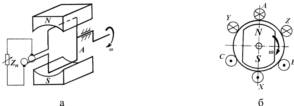
Рисунок 3.1 – Макети однофазної зворотної конструкції (а) та трифазної прямої конструкції (б) синхронних генераторів
