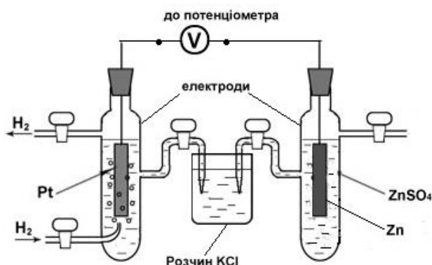
Рисунок 9.4 – Визначення стандартного потенціалу цинка (-) \text{Zn} | \text{ZnSO}_4 || \text{H}_2\text{SO}_4 | (\text{H}_2) \text{Pt} (+)
