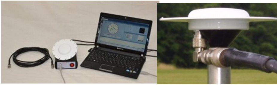
Рисунок 3.2 – EPSBase-6GG двочастотна базова GNSS-станція з антеною (URL: https://eps.com.ua/article/base-station/ )
