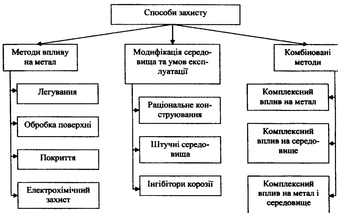
Рисунок 9.3 – Класифікація способів захисту від корозії
