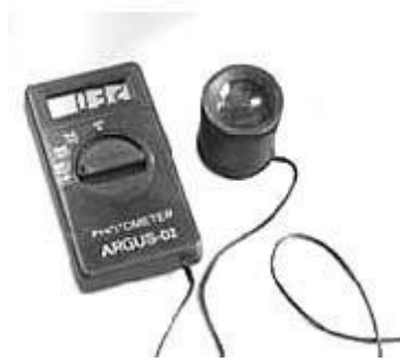
Рисунок 14.6 – Зовнішній вигляд яскравоміра «Аргус-02»
