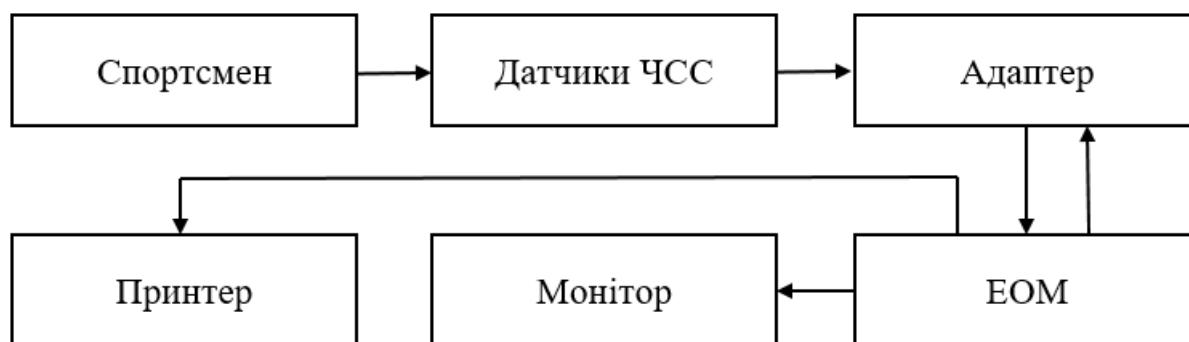
Рисунок 1 – Структурна схема САК
