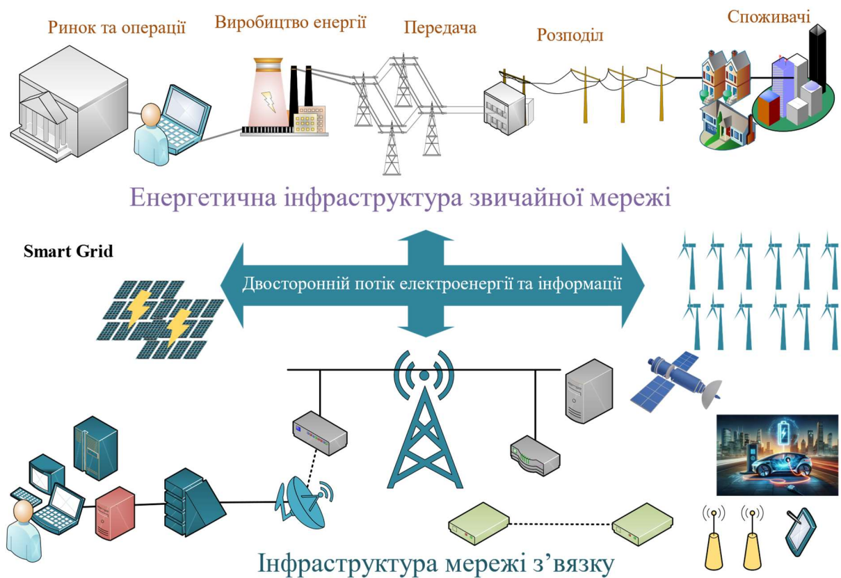
Рисунок 1.6. – Електромережа з використанням технологій інтелектуалізації Smart Grid.
