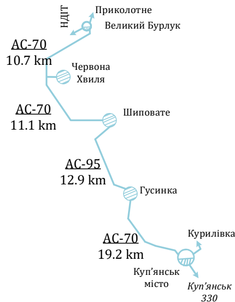
Рисунок 2.2 – Схематичне зображення ділянки мережі електропостачання Куп'янськ та Великий Бурлук
