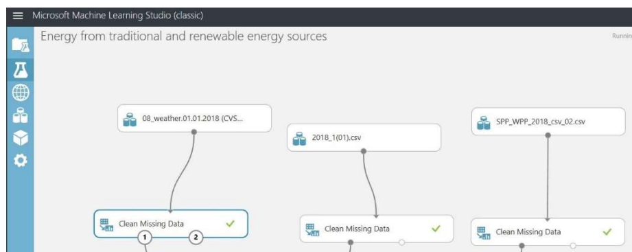
Рисунок 4.20 – видалення рядків із втраченими даними за допомогою блоку «Clean Missing Data»
