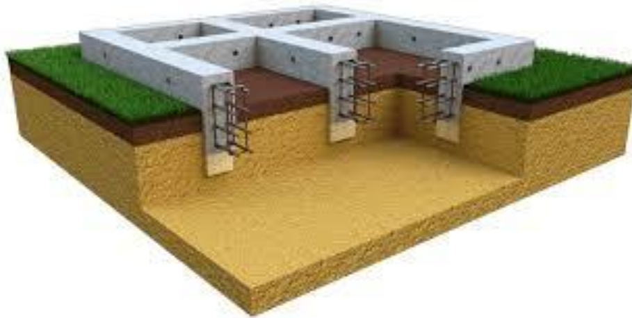
Рисунок 1.2 – Монолітний стрічковий фундамент
