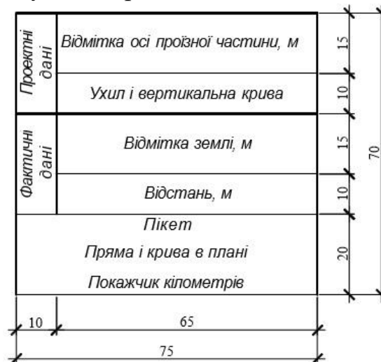
Рисунок 8 – Спрощений боковик таблиці-сітки поздовжнього профілю, який можна використовувати у курсовому проєкті
