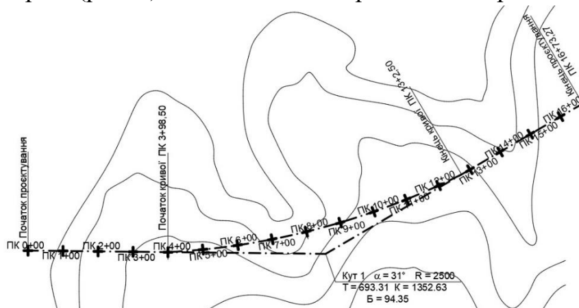
Рисунок 6 – Розбивка пікетажу на плані траси
