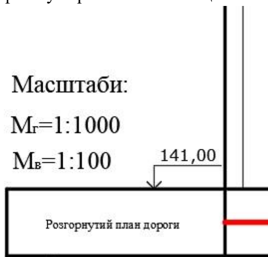
Рисунок 10 – Призначення нульової (початкової) відмітки
