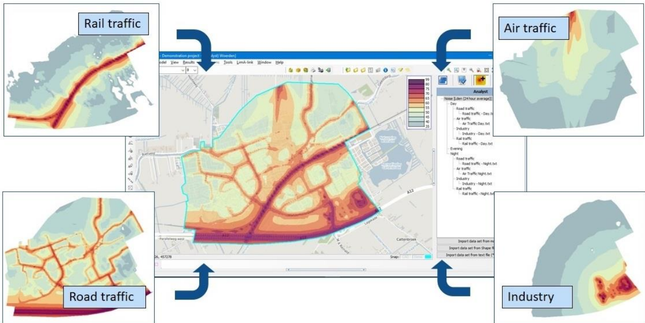
Рисунок 2 – Ситуаційна шумова карта міста на основі вимірювань рівнів шуму автотранспортних магістралей та подальшого розрахунку у програмному комплексі Softnoise
