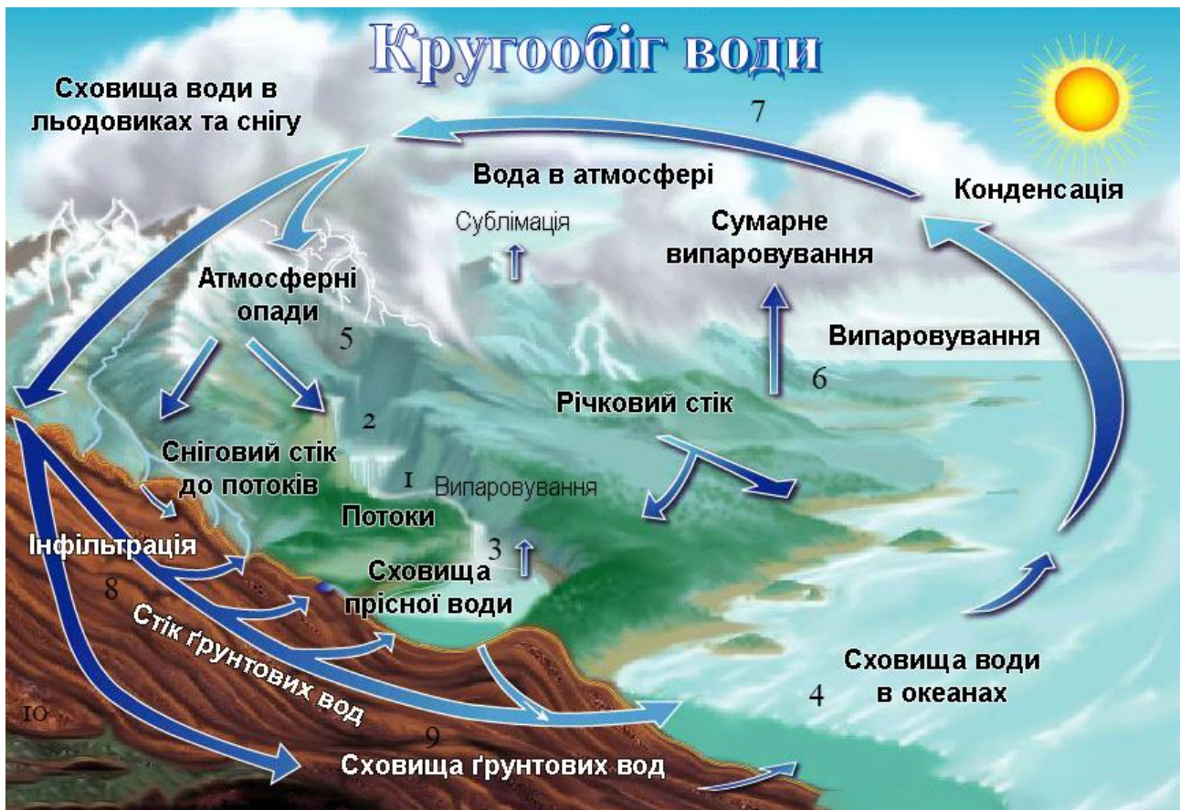
Рисунок 13 – Внутрішньоматериковий кругообіг води: 1 – річка; 2 – озеро; 3 – водосховище; 4 – океан; 5 – опади; 6 – випаровування; 7 – напрямок руху води; 8 – водопроникні породи; 9 – слабопроникні породи; 10 – водонепроникні породи
