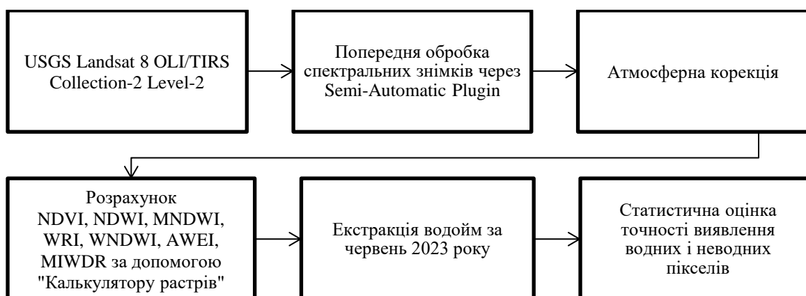
Рисунок 1 – Алгоритм обробки знімків Landsat 8 для екстракції водних об'єктів
