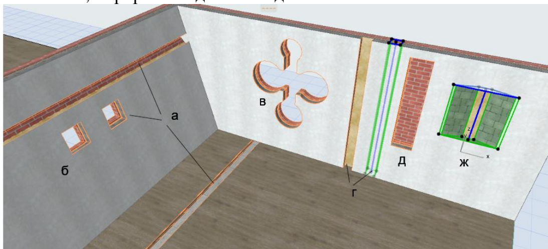
Рисунок 2.9 – Варіанти побудови отворів: а – горизонтальний; б – перпендикулярно до елемента; в – перпендикулярний з відредагрованою формою; г – вертикальний з різною лінією прив'язки; д – вертикальний з обмеженням з обох боків; ж – вертикальний з обмеженням та зміною форми
