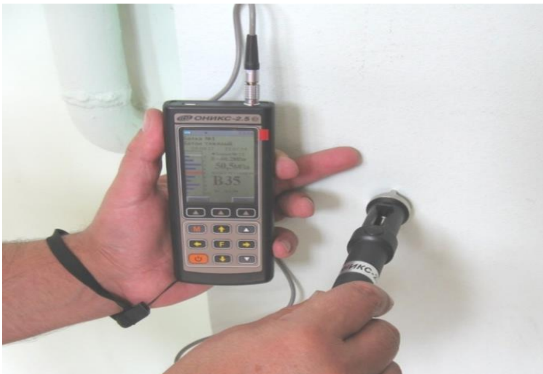
Рисунок 3.10 – Визначення міцності бетону електронним приладом ударної дії типу «Онiкс-2,5»
