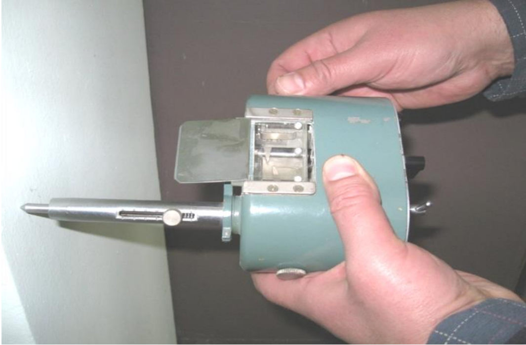
Рисунок 4.17 – Робота з вібрографом ВР-1 при вимірюванні вібрацій
