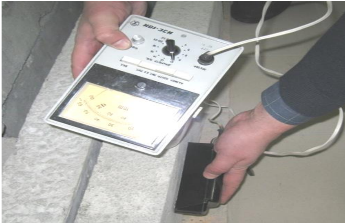
Рисунок 3.17 – Робота по визначенню параметрів армування залізобетонних конструкцій приладом типу ІЗС-10Н
