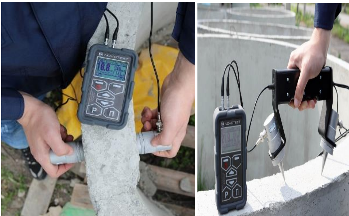
Рисунок 3.15 – Робота з визначення міцності бетону переносним ультразвуковим приладом
