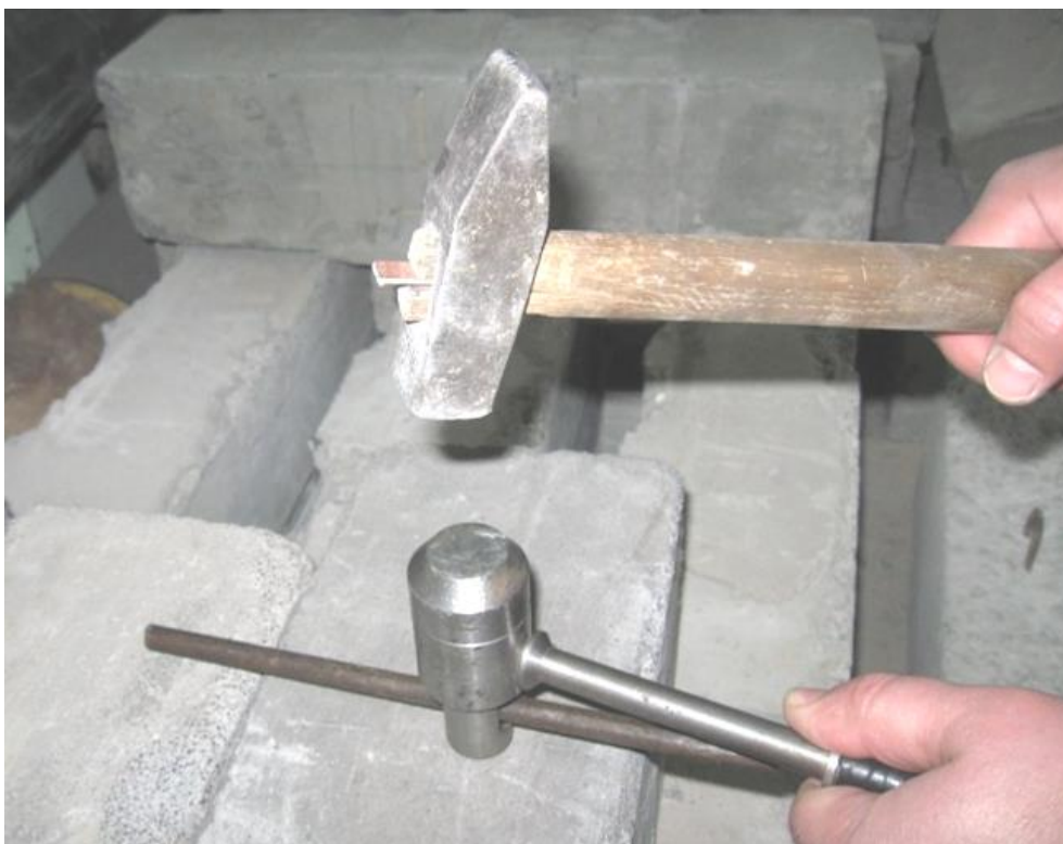
Рисунок 3.7 – Работа с молотком К. П. Кашкарова при определении прочности бетона
