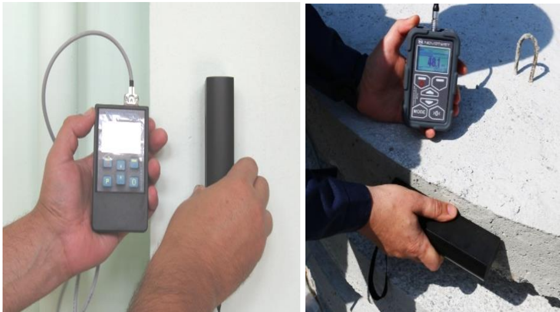
Рисунок 3.18 – Робота по визначенню параметрів армування залізобетонних конструкцій електронним електромагнітним приладом «Novotest»
