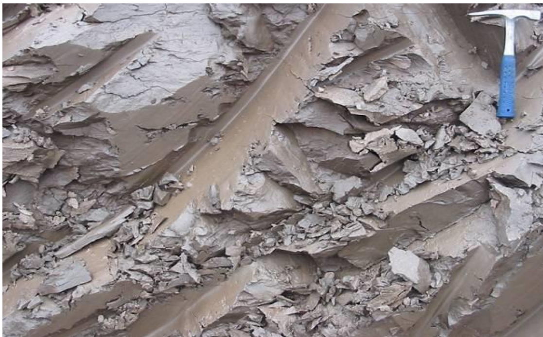
Рисунок 2.5 – Монтморилонітова глина, що формується в мілководних басейнах в умовах посушливого клімату та набухає під час осмотичного поглинання води ( https://tradio.wiki/files/thumb/2/2c/Clay-ss-2005.jpg/300px-Clay-ss-2005.jpg )
