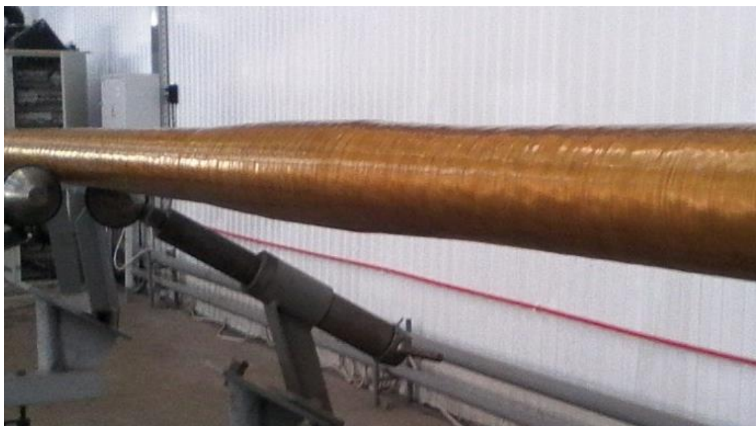
Рисунок 7.13 – Ділянка потовщення стінки труби, армованої волокном
