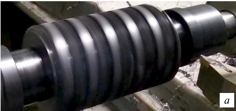
Рисунок 5.13 – Виробництво черв'ячного гвинта: налагодження процесу (а) і виготовлених деталей (б)
