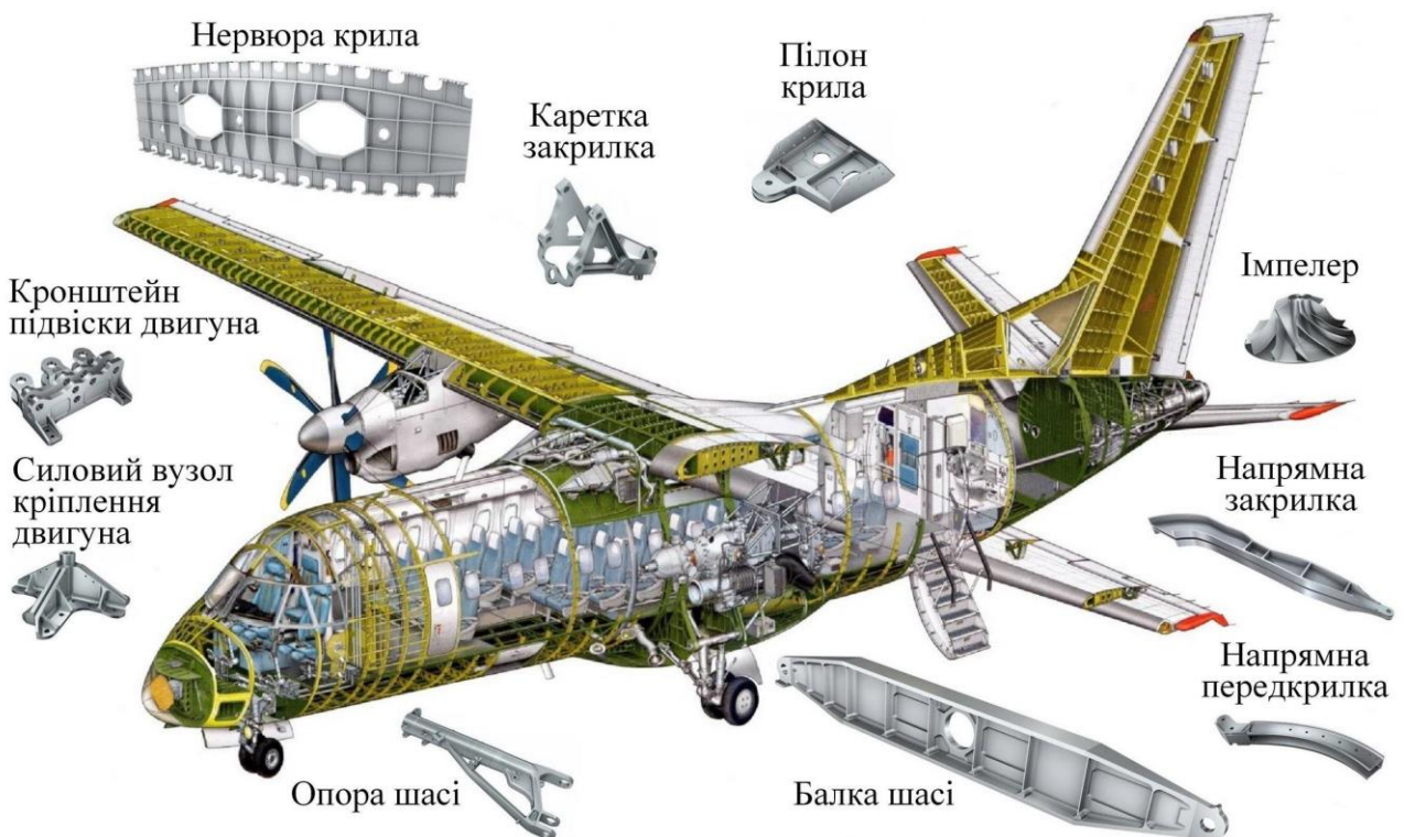
Рисунок 1.2 – Типові монолітні деталі, що використовуються в конструкціях літаків [222]
