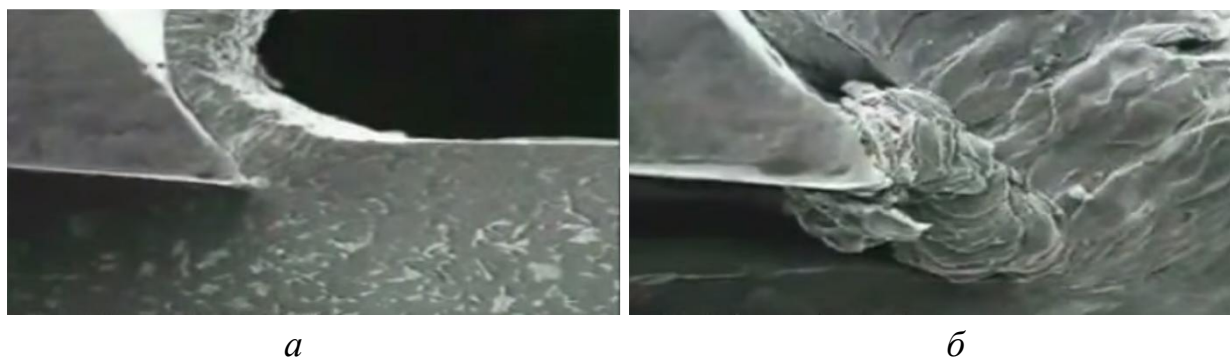
Рисунок 4.12 – Фрагмент процесу різання [236]: a – нормальний процес різання; б – різання з налипанням (матеріал налипає до інструменту)
