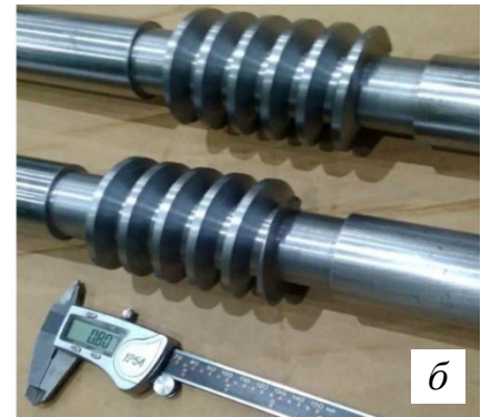
Рисунок 5.13 – Виробництво черв'ячного гвинта: налагодження процесу (а) і виготовлених деталей (б)
