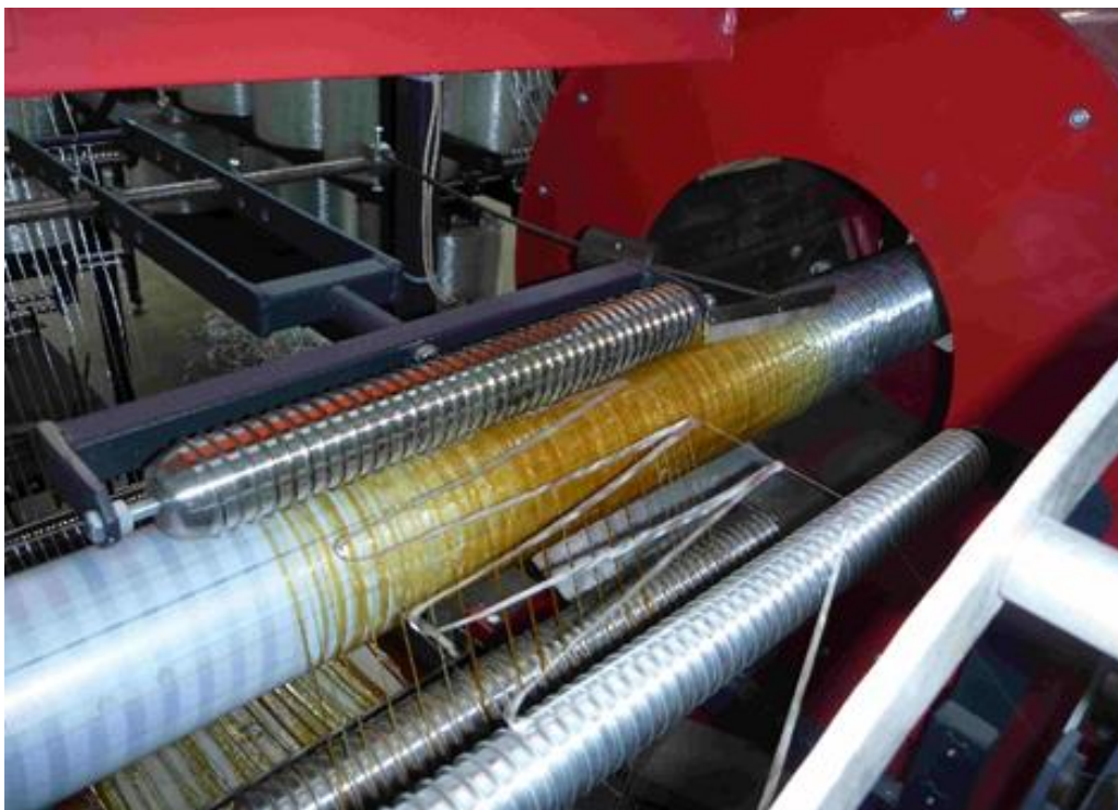
Рисунок 7.15 – Формування конструкції труби
