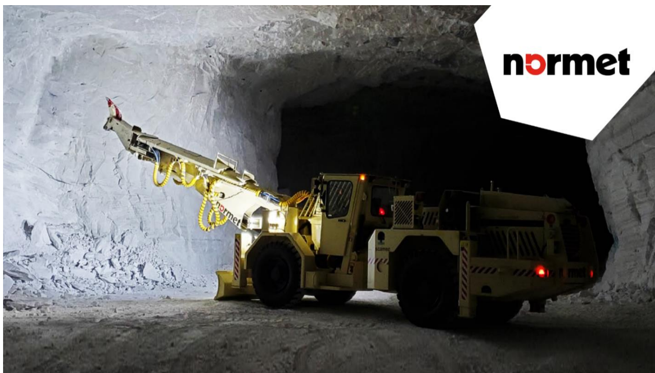
Рисунок 48 – Загальний вигляд оборника компанії НОРМЕТ на пневмоходу зі стрілою та гідромолотом на кінці
