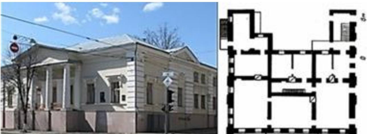
Рисунок 12.2 – Міська садиба колезького секретаря фон Мінстера (1834 р., пам'ятка архітектури): а – сучасний вигляд; б – план парадного поверху з анфіладою кімнат
