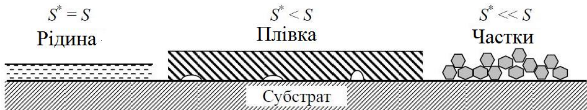
Рисунок 2.10 – Адгезія рідини, плівки та частинок: s^* – площа реального адгезійного контакту; s – площа поверхні субстрату, на яку нанесено адгезив
