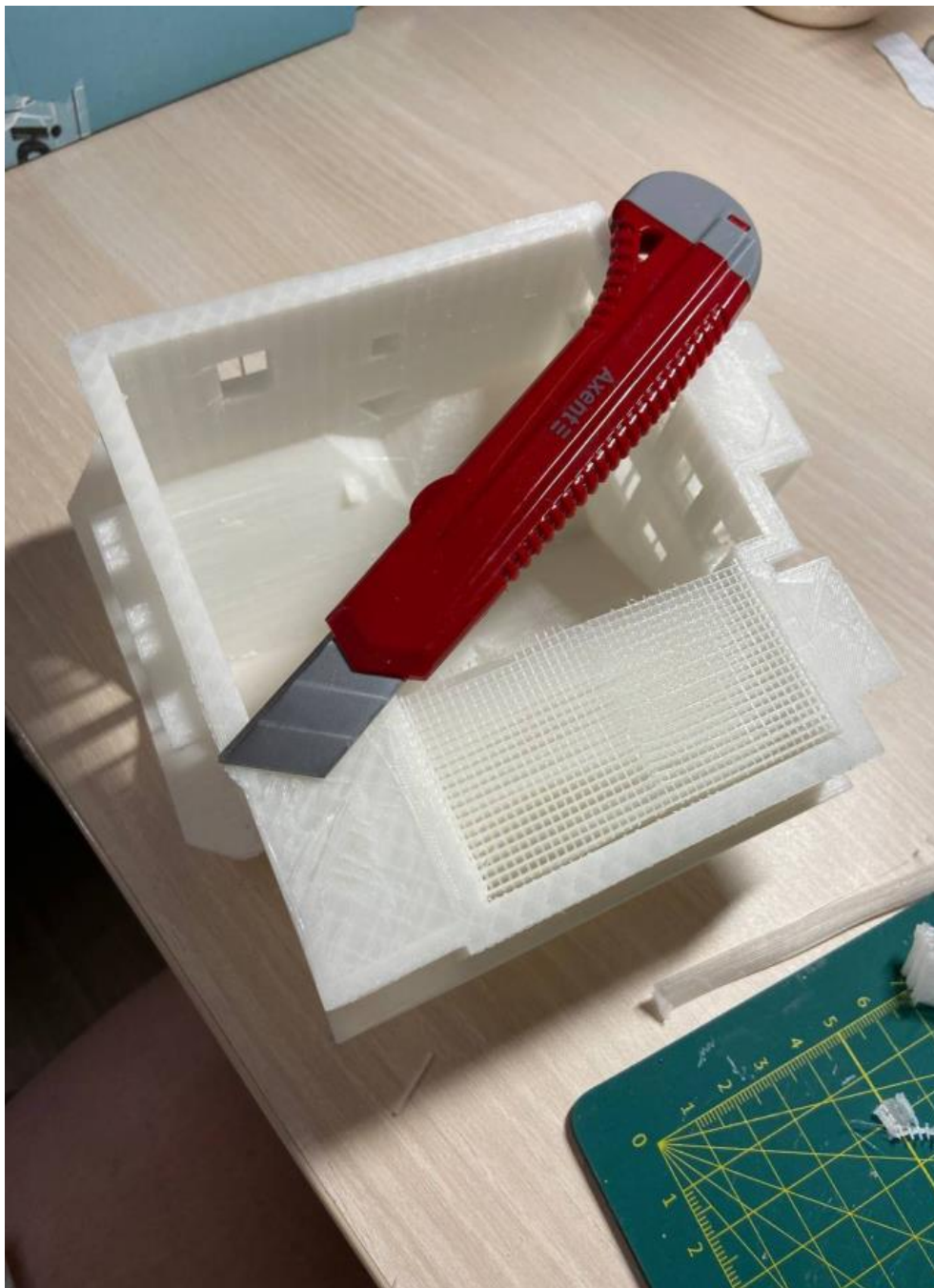
Рисунок 16 – Етапи зрізання підпірок з отриманої моделі макету будівлі
