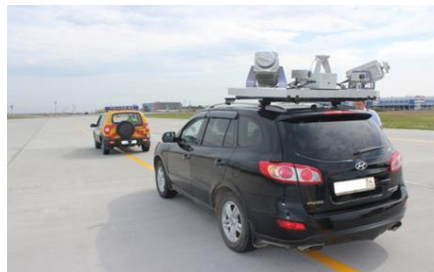
Рисунок 5.5 – Виконання зйомки за допомогою мобільного лазерного сканувального пристрою
