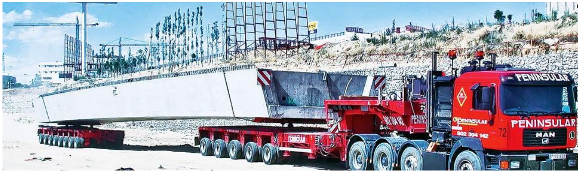
Рисунок 3.1 – Перевезення наддовгих деталей великовантажним транспортом
