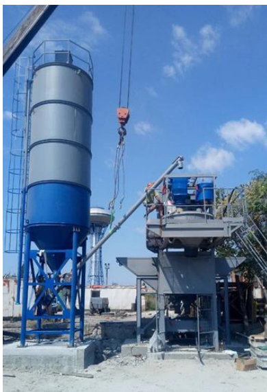
Рисунок 4.13 – Інвентарний швидкокорозбірний бетонний вузол
