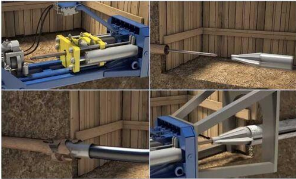
Рисунок 1.45 – Безтраншейне прокладання каналізації технологією санації
