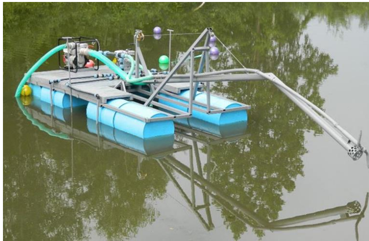
Рисунок 2.5 – Транспортування ґрунту землесосними снарядами
