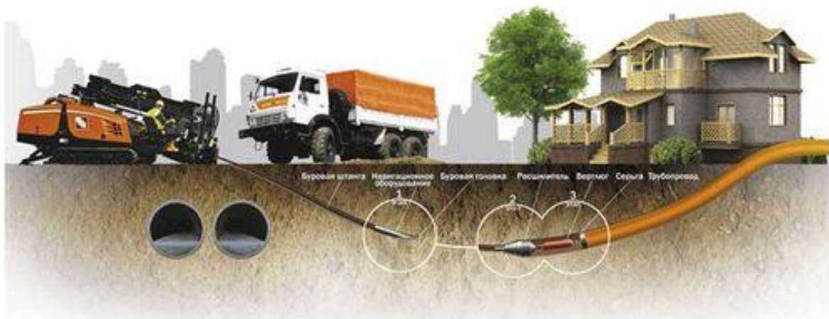
Рисунок 1.47 – Спосіб направленої шнекової буріння
