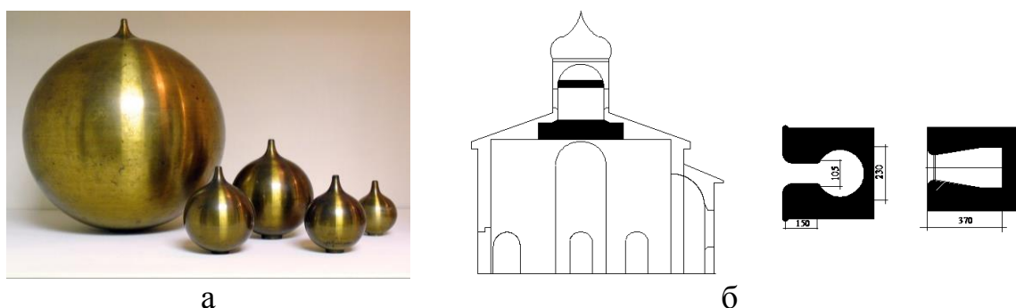
Рисунок 16.2 – Акустичні резонатори: а – резонатор Гельмгольца; б – резонатори (голосники) для посилення звуку хору і збільшення реверберації [57]
