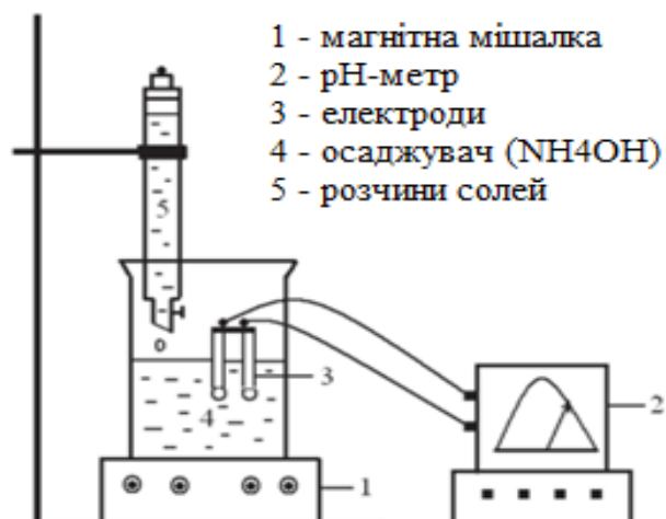
Рисунок 2 – Схема установки для осадження гідроксидів у системі ZrO_2 - Y_2O_3 - CeO_2
