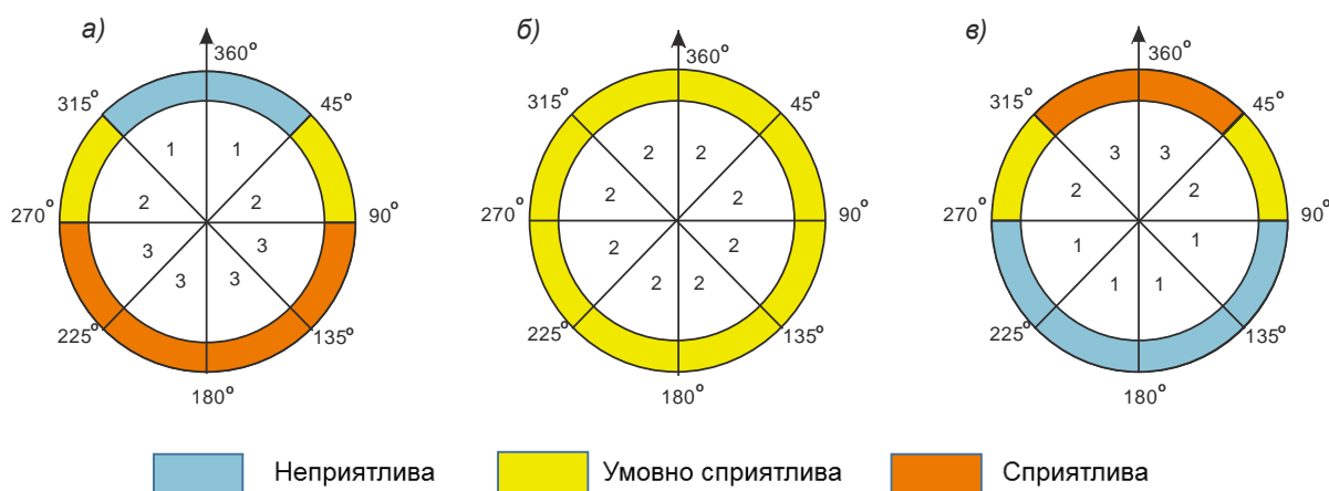
Рисунок 1.14 – Оцінка кола обрїю за тепловим впливом сонячної радіації на територію забудови в літній період: а – на північ від 57,5 ° п. ш.; б – у діапазоні 47,5–57,5 ° п. ш.; в – на південь від 47,5 ° п. ш.
