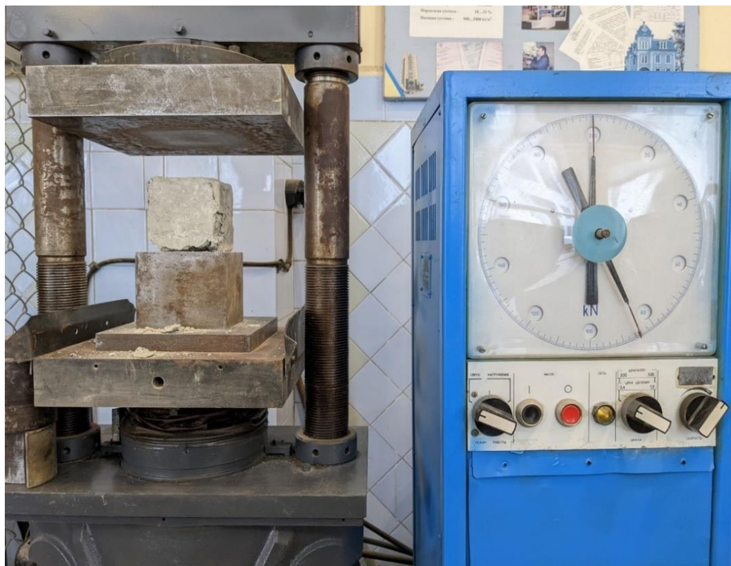
Рисунок 4.2 – Випробування на міцність при стисканні зразків бетону після перебування в біокамері
