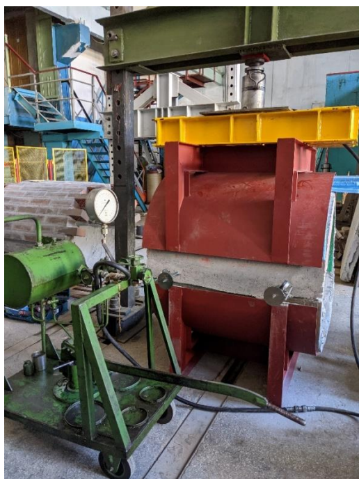
Рисунок 4.7 – Установка для випробувань відновленого колектора на зовнішнє зусилля
