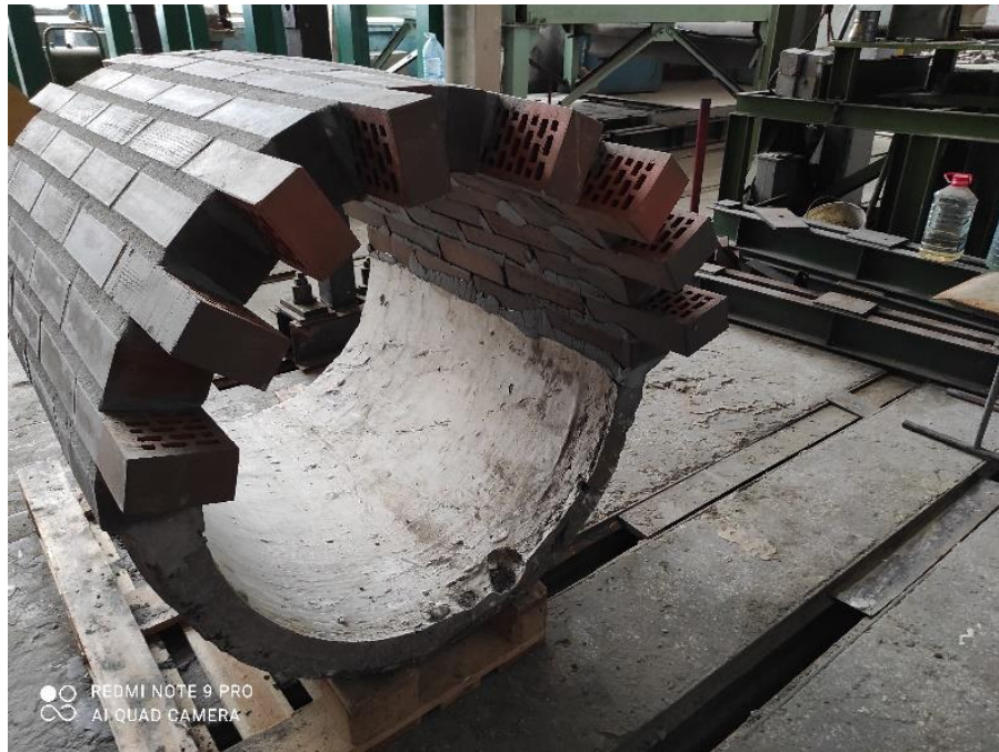
Рисунок 1.10 – Конструкція склепіння Ø800 мм (лабораторні випробування)
