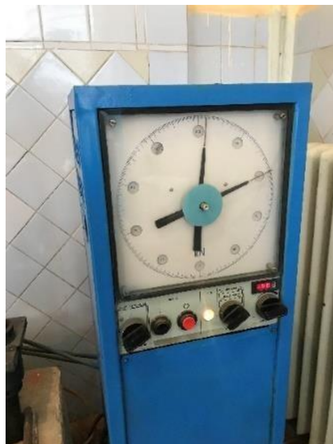
Рисунок 3.19 – Міцність зразка на вигин - 250x120x30 мм:
