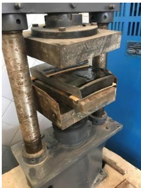
Рисунок 3.19 – Міцність зразка на вигин - 250x120x30 мм:
