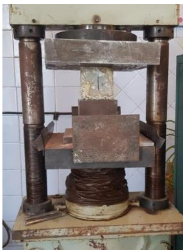
Рисунок 3.22 – Лабораторне випробування зразка після перебування в агресивному середовищі оглядової шахти на стиск
