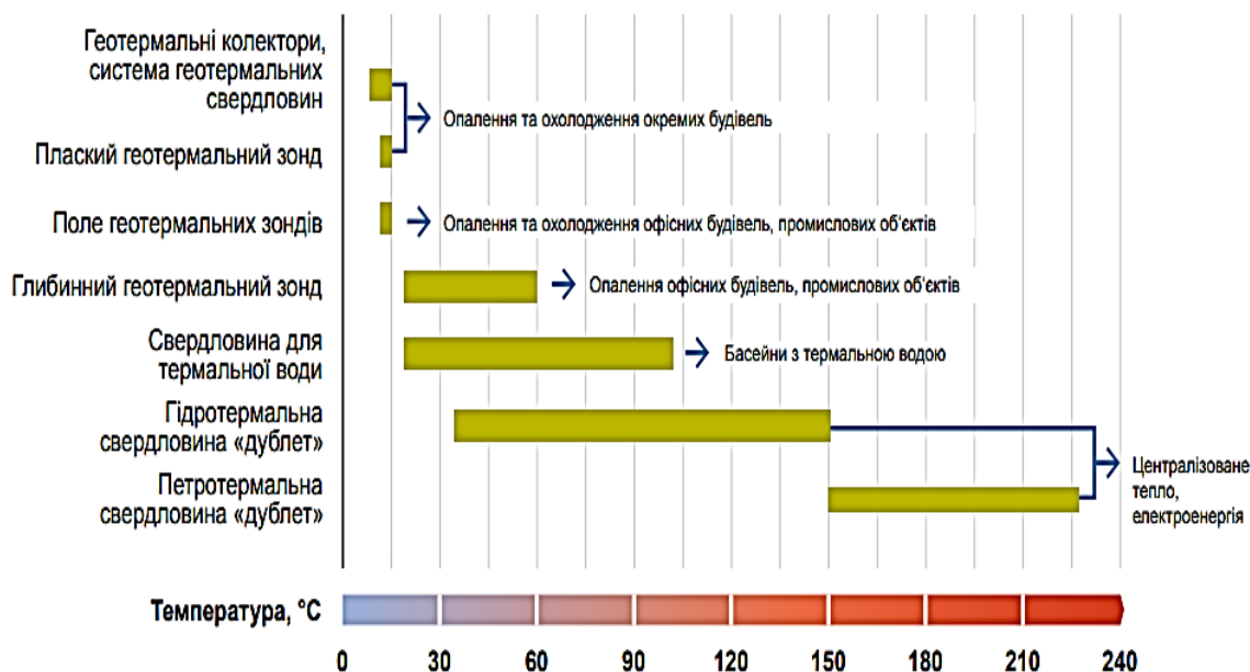
Рисунок 2.2 – Використання геотермії та необхідна для цього техніка, а також можливий температурний діапазон [190]
