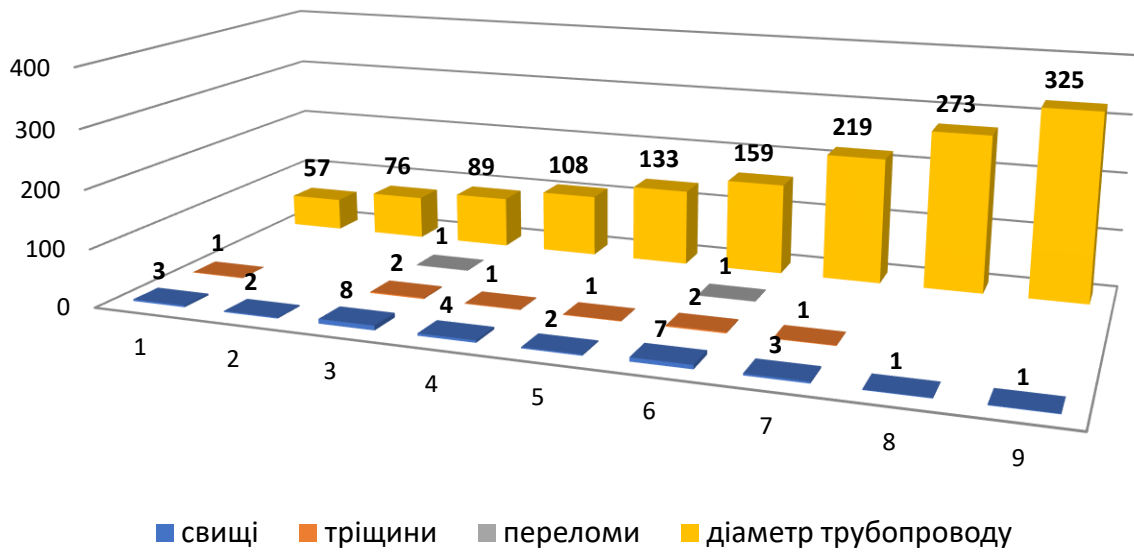
Рисунок 1.35 – Кількість аварій залежно від типу дефекту та діаметра теплопроводу гарячого водопостачання
