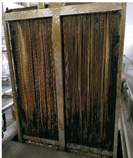
Рисунок 3.4 – Налипання на мембранах: а – загальний вид мембранного блоку, б – налипання, зняті з мембрани
