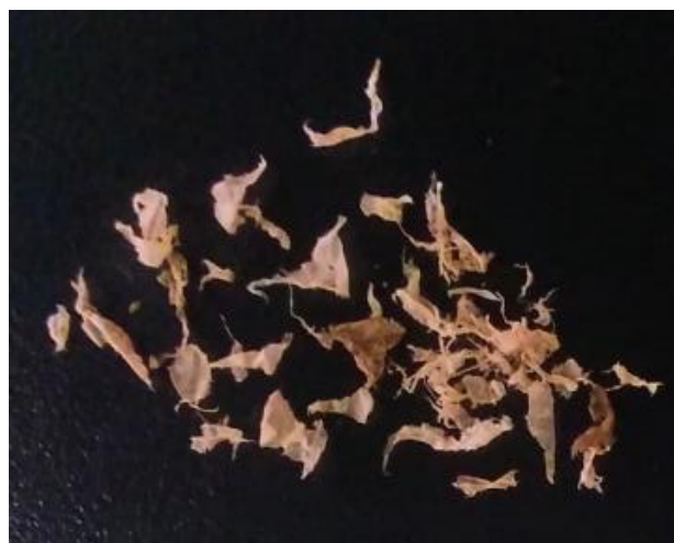
Рисунок 3.6 – Мікропластик в налипаннях на мембранах
