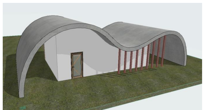
Рисунок 2.12 – Створення складної покрівлі за допомогою оболонки: зліва – побудова контуру-сплайну; справа – вигляд готової оболонки
