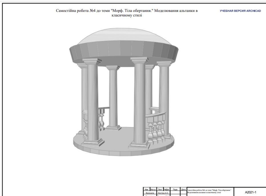
Рисунок А.2 – Зразок оформлення графічної роботи до теми «Методика концептуального моделювання за допомогою інструменту «морф»: тіла обертання. Створення альтанки в класичному стилі»
