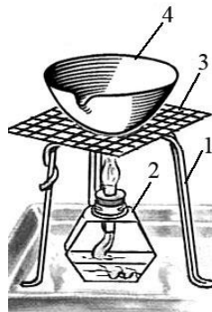
Рисунок 16 – Засіб для пропарювання: 1 – тринога, 2 – спиртівка, 3 – азбестова сітка, 4 – випарювальна чашка
