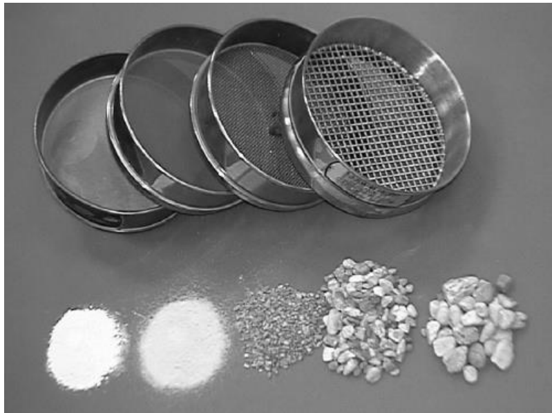
Рисунок 7.1 – Набір сит для аналізу гранулометричного складу крупноуламкових і піщаних ґрунтів
