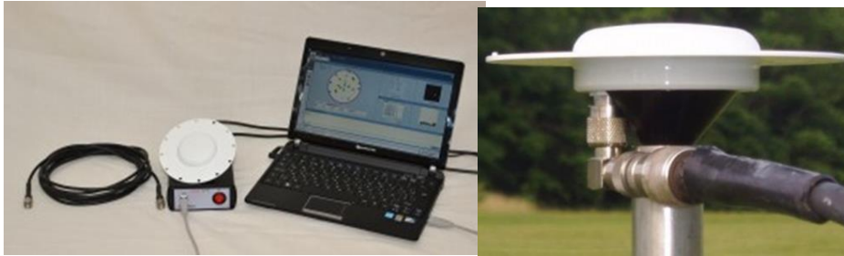
Рисунок 3.2 – EPSBase-6GG двочастотна базова GNSS станція з антеною (URL: https://eps.com.ua/article/base-station/ )
